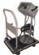
Спектрометр для паспортизации несортированных радиоактивных отходов СЕГ-001м «АКП-С»-ТРО
