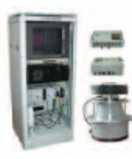
Программно-технический комплекс для определения протечек в парогенераторе по активности в остром паре «Азот-16-ПГ»
