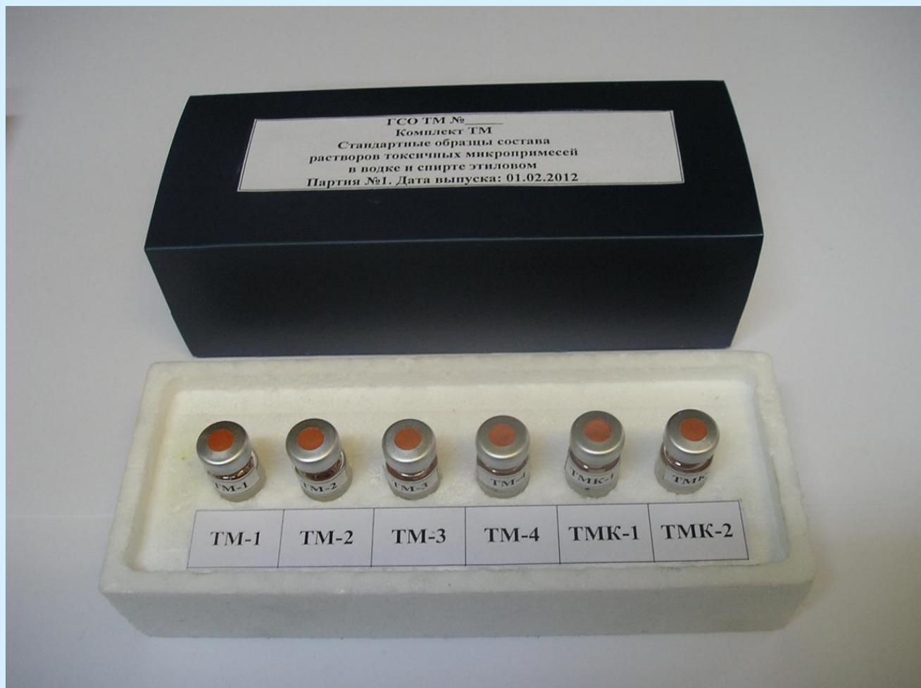
Прототип стандартных образцов (CRM) компонентного состава летучих токсичных микропримесей алкогольной и спиртосодержащей продукции. Традиционные 2 мл виалы с септой под кримпер для непосредственного использования в автосэмлерах.
