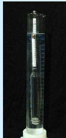
С помощью ареометра или пикнометра измеряют непосредственно величину плотности исследуемой жидкости, обусловленную концентрацией безводной составляющей спиртосодержащего образца и концентрацией воды.
