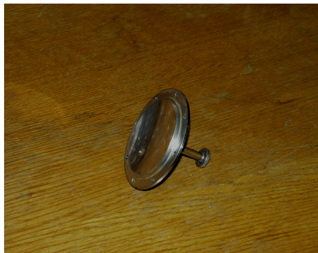
Рис. 9. Зеркало ОР с плавным волноводным переходом
