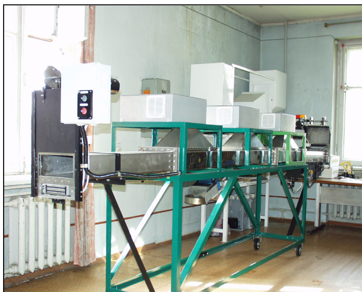
Рис. 14. Оборудование для микроволновой стерилизации пищевых добавок
